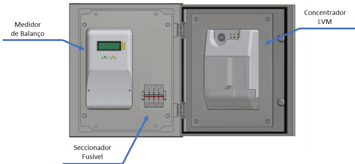
Figura 2 - Detalhes da Montagem da Caixa do Concentrador e Medidor de Balanço
